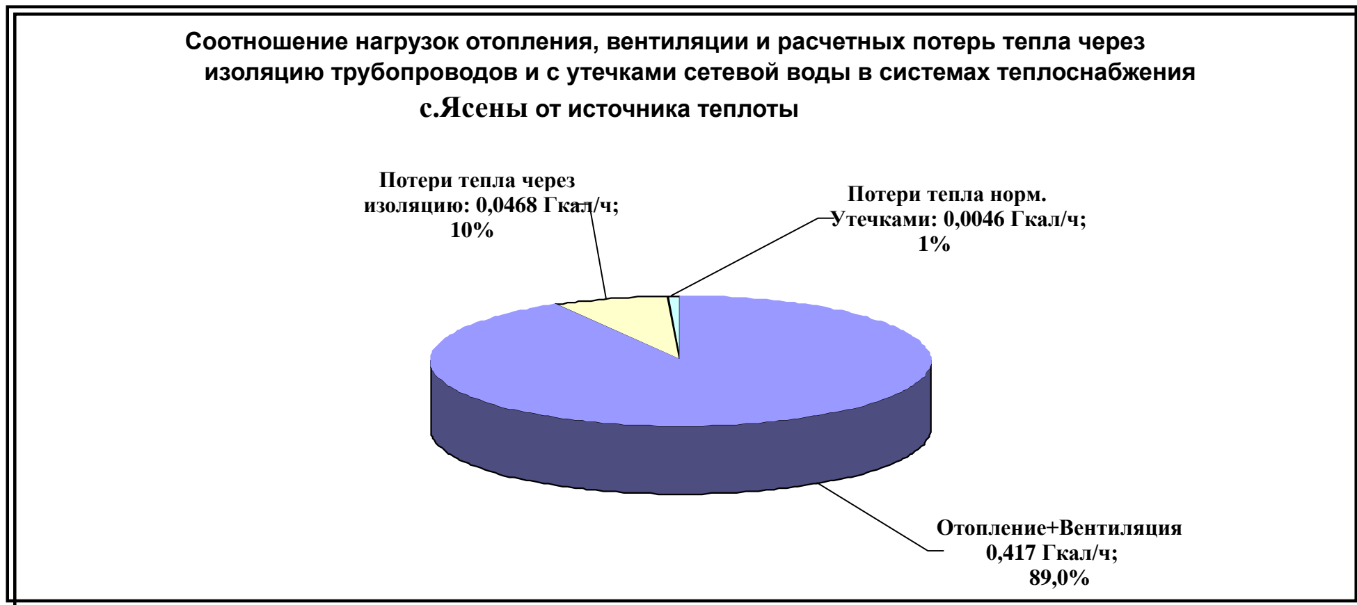
Рис.1.3.Соотношение нагрузок отопления, вентиляции и расчетных потерь в системах теплоснабжения с.Ясены от всех источников теплоты
