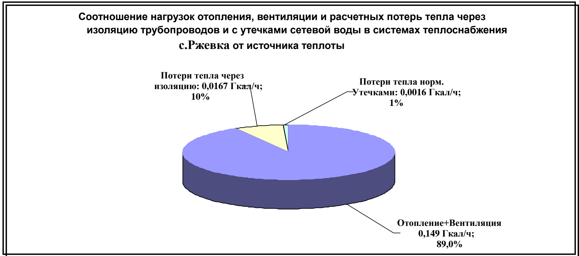
Рис.1.2.Соотношение нагрузок отопления, вентиляции и расчетных потерь в системах теплоснабжения с.Ржевка от всех источников теплоты
