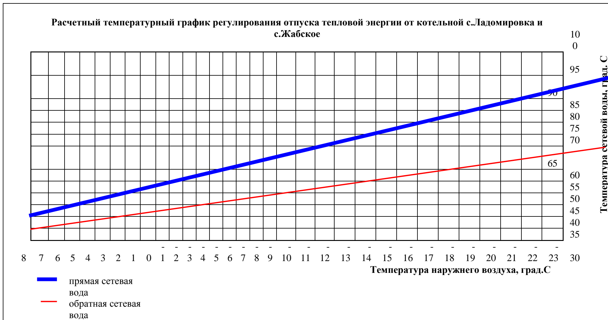
Рис.5.1. Расчетный температурный график регулирования отпуска тепловой энергии от котельной с.Ладомирровка и с.Жабское
